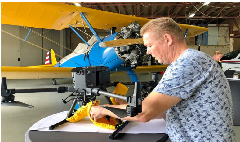
In opdracht van DroneQ werd een add-on ontwikkeld waarmee op afstand een zwemvest kan worden gedropt bij een drenkeling.
